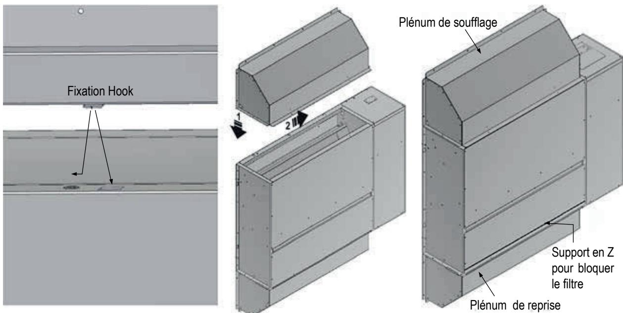
Unité complète avec plenum de reprise et soufflage. Cet appareil et le plenum sont déjà préparés (sauf fixation : vis...) avec les trous pour la mise en place des vis, comme indiqué sur la photo.
