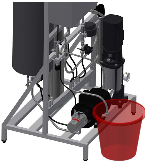
Fig. 23: Rinçage du réservoir OI
