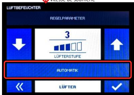
Fig. 5.5.2 : Réglage de la vitesse de soufflerie
