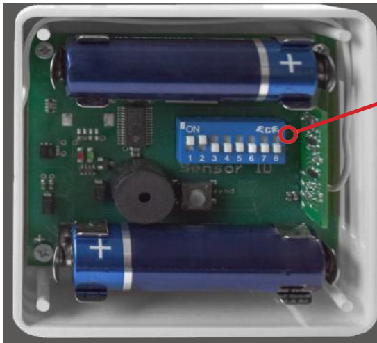
Fig. 5.6.4 : Codage de l'émetteur radio d'humidité
