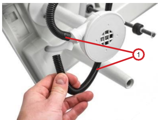
Fig. 6.3.4.4 : Retirer les tuyaux de la pompe
