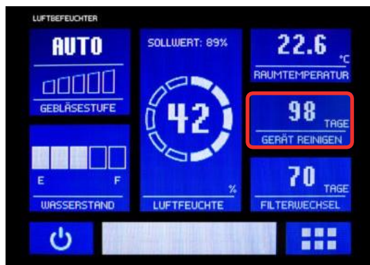
Fig. 5.1.6 : Affichage du prochain nettoyage recommandé
