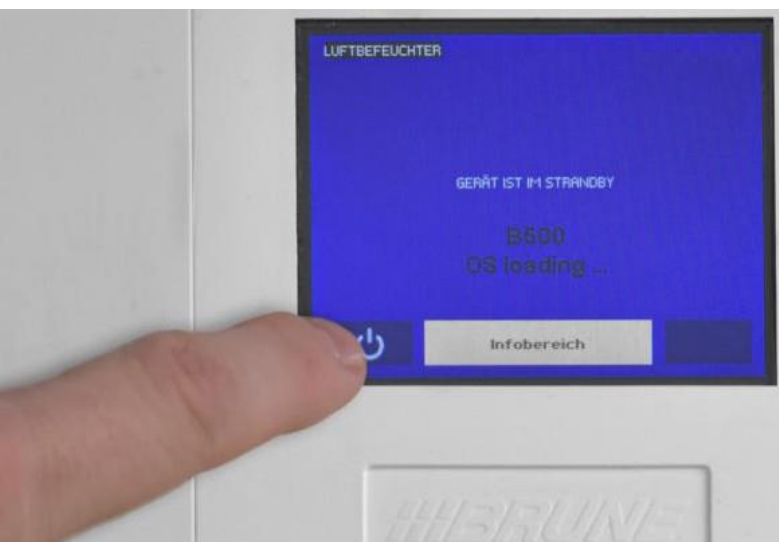
Fig. 4.3.6 : Mettre en marche l'humidificateur d'air
