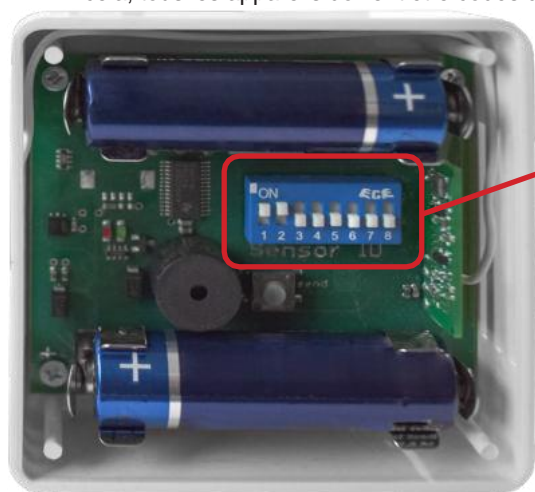
Fig. 5.6.1 : Vue intérieure de l'émetteur radio d'humidité
