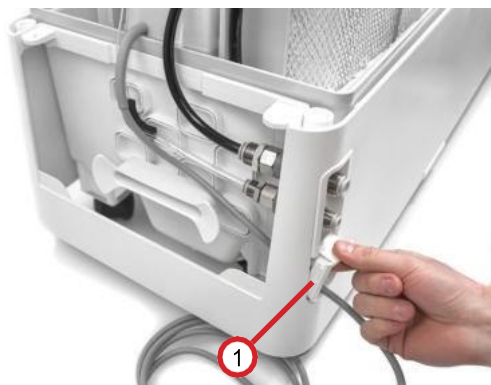
Fig. 4.3.2 : Retirer la partie supérieure du boîtier
