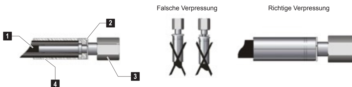
Abb. 20: Verpressung der Hochdruckschläuche
