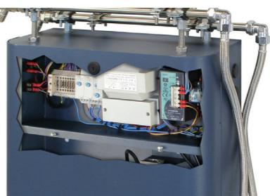
Protection IP54 en standard, tous les composants internes étant facilement accessibles pour le fonctionnement et l'entretien. Les composants électriques sont placés dans une zone séparée au-dessus des conduites d'eau et d'air.
