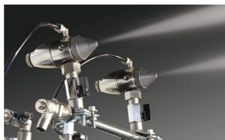
Une broche intégrée empêche les obstructions, ce qui se traduit par un fonctionnement fiable dans le domaine industriel. Les buses sont disponibles en différents niveaux de puissance et peuvent être réglées dans le sens horizontal et vertical.
