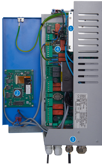
Alimentation électrique [1] Tableau de contrôle [2] Boîtier thermo-laqué [3] Spa Control [4]
