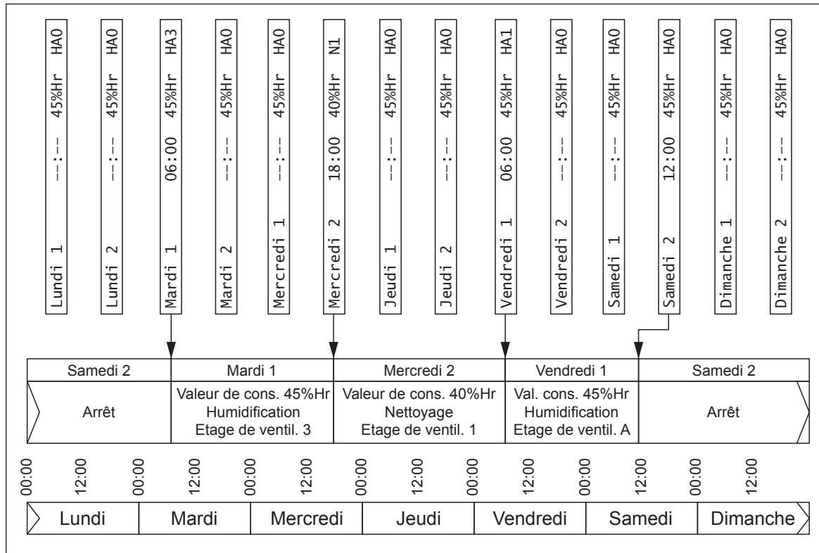
La détermination des programmes et l'activation de l'exploitation programmée s'effectuent dans le "plan timer".
