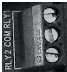
Dabei handelt es sich um zwei spannungsbehaftete NO-Kontakte mit einem gemeinsamen Leiter 12VDC (COM), die mit 100mA pro Ausgang belastet werden dürfen. Der Gesamtstrom beider Ausgänge darf 200mA nicht überschreiten. Wenn Sie potentialfreie Meldeausgänge benötigen, wird der bauseitige Einbau von zwei Trennrelais mit 12 VDC/max. 100 mA empfohlen. Überprüfen Sie die Einbaumaße der Relais vor deren Montage unter den Steuerdeckel.
