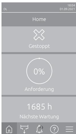
Betriebsstörungen, die einen Weiterbetrieb nicht zulassen oder zu Schäden an der Anlage führen können, werden mit einer Fehlermeldung signalisiert, zusätzlich leuchtet die Status-LED rot. Beim Auftreten einer solchen Störung ist der Betrieb des Condair DL nur noch beschränkt möglich oder der Condair DL **wird gestoppt**.
