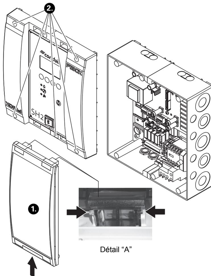
1. Déverrouiller le capot transparent et le basculer vers le haut, déverrouiller les deux charnières (voir le détail "A") et enlever le capot.
