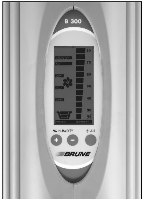
Die Anzeige und Einstellung der relativen Luftfeuchtigkeit erfolgt in 5%-Schritten. Daher kann es zu Abweichungen der Anzeige zu anderen Messgeräten kommen. Jeweils bei 3% und 8% springt die Anzeige auf den nächst höheren Anzeigewert (z.B. Ist-Feuchte = 43% entspricht der Anzeige = 45%)
