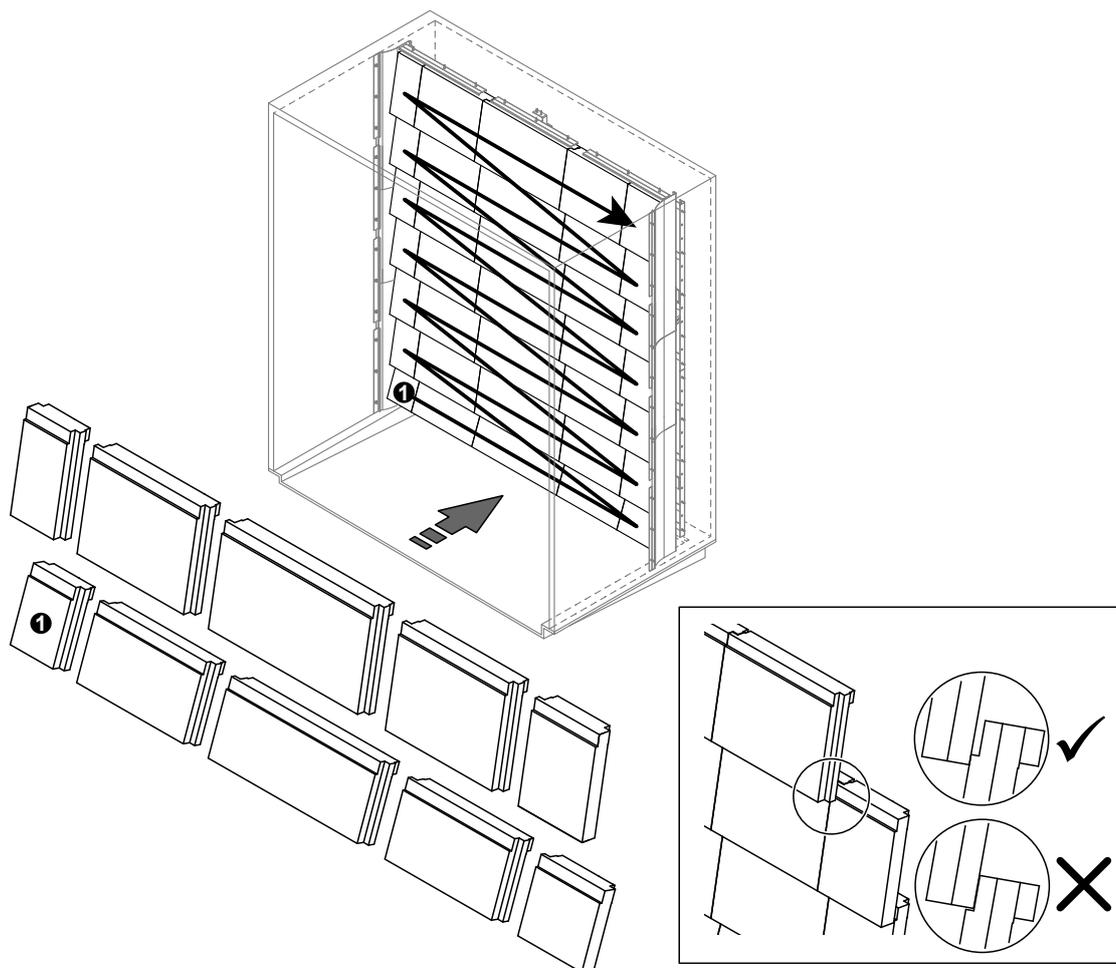
Abb. 22: Keramikplatten einsetzen
