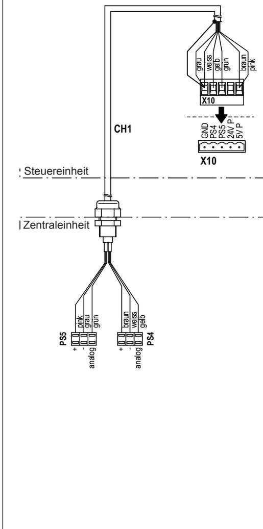
Der Kabelbaum "CH1" (Drucksensoren) ist ab Werk an den entsprechenden Drucksensoren in der Zentraleinheit angeschlossen. Der Stecker des Kabelbaums muss gemäss dem Schema auf die entsprechende Anschlussbuchse (X10) auf der Treiberplatine in der Steuereinheit aufgesteckt werden. Der Kabelbaum ist über die rechteckige Kabeleinführungsleiste in die Steuereinheit zu führen.
