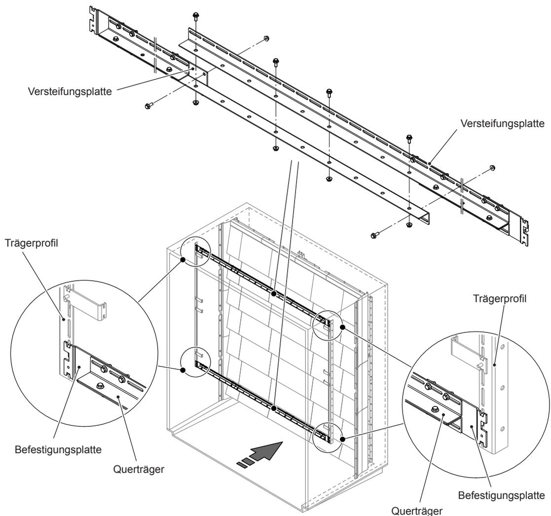
Abb. 26: Querträger montieren
