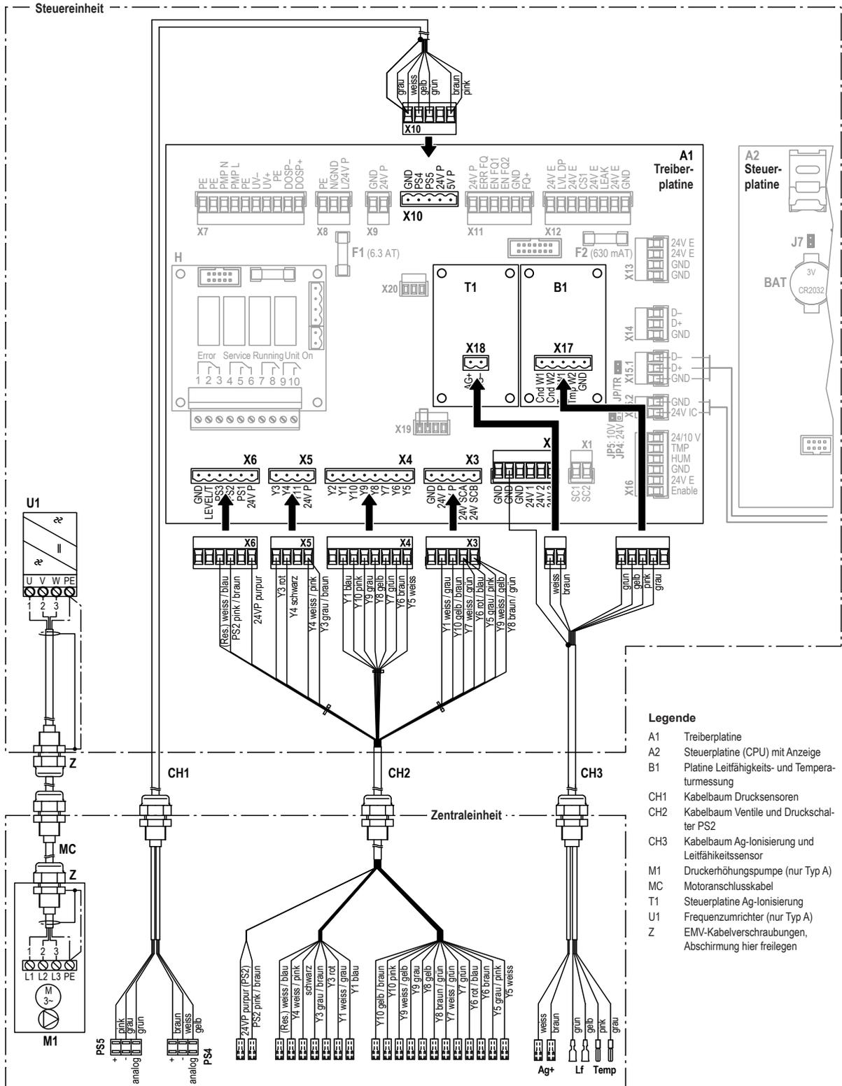
Abb. 38: Anschlussschema Zentraleinheit - Steuereinheit
