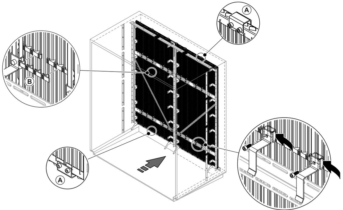
Abb. 17: Boosterelemente montieren
