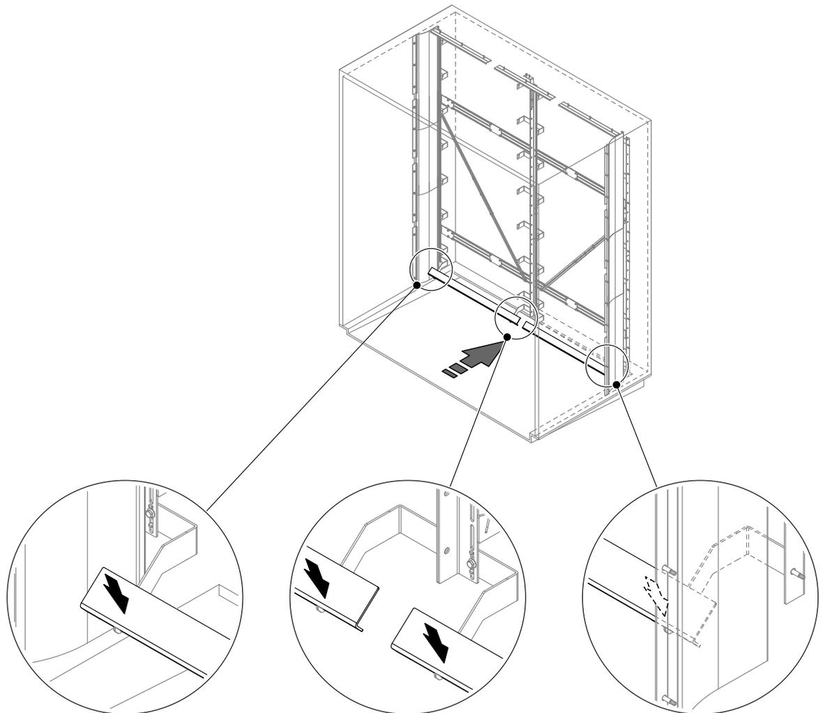
Abb. 19: Keramik-Abstützprofile in die Haltebügel einlegen
