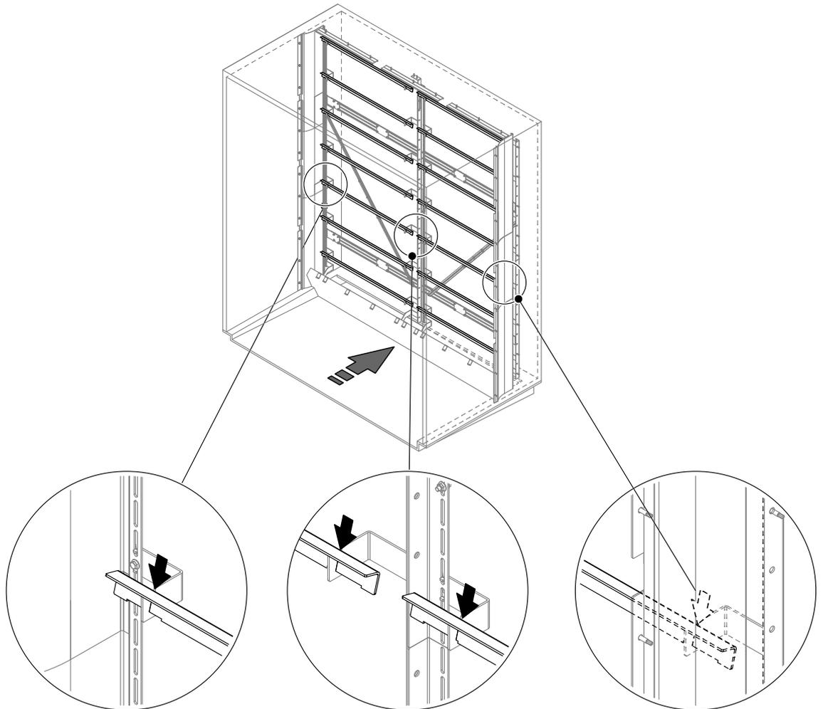
Abb. 21: Keramik-Trägerprofile in die Haltebügel einlegen
