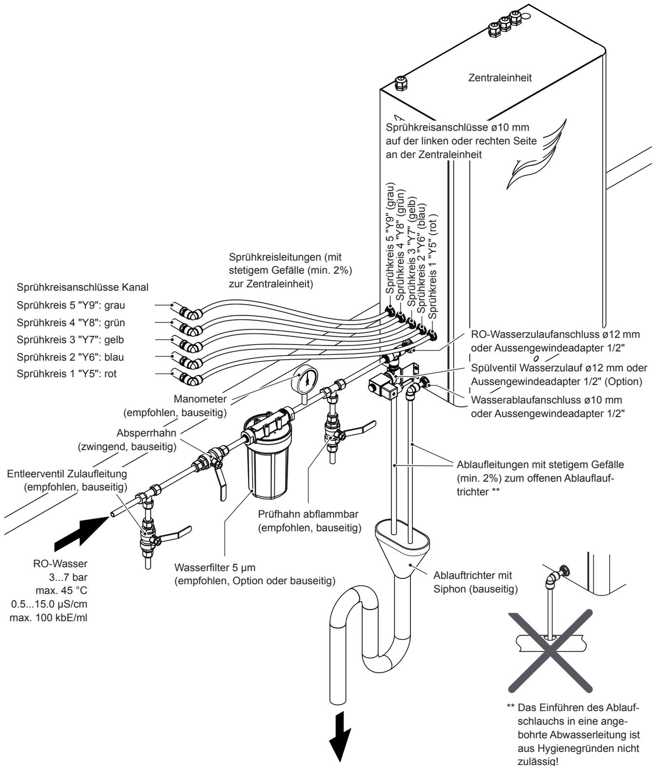
Abb. 36: Übersicht Wasserinstallation
