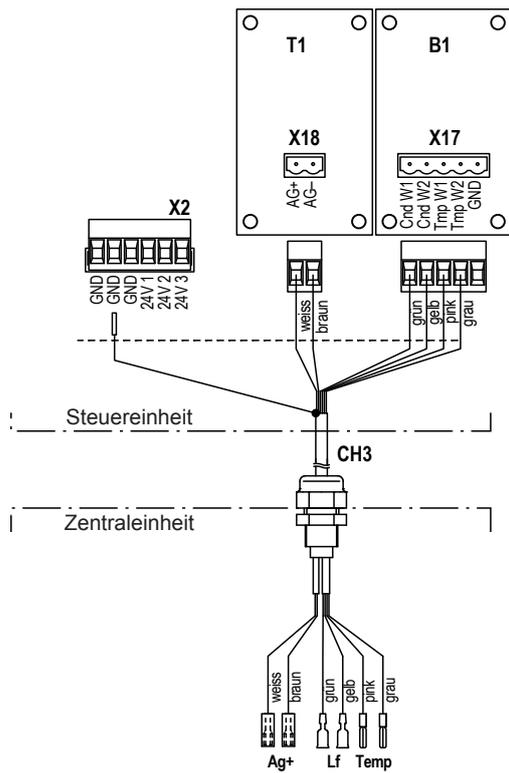
Der Kabelbaum "CH3" (Ag-Ionisierung und Lf-Messung) ist ab Werk an der Silberionisierpatrone und dem Leitwertsensor in der Zentraleinheit angeschlossen. Die Stecker des Kabelbaums müssen gemäss dem Schema auf die entsprechenden Anschlussbuchsen auf der Ag-Ion-Platine (X18) und der Leitwertmessplatine (X17) in der Steuereinheit aufgesteckt werden.
