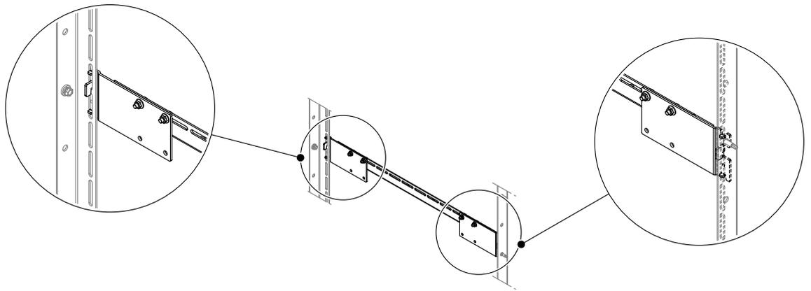
Abb. 15: Querträger für Boostermontage bei Anlagen bis 2100 mm Breite montieren
