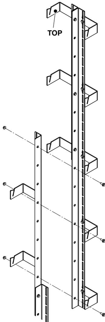
Abb. 11: Vertikalstütze(n) zusammenbauen
