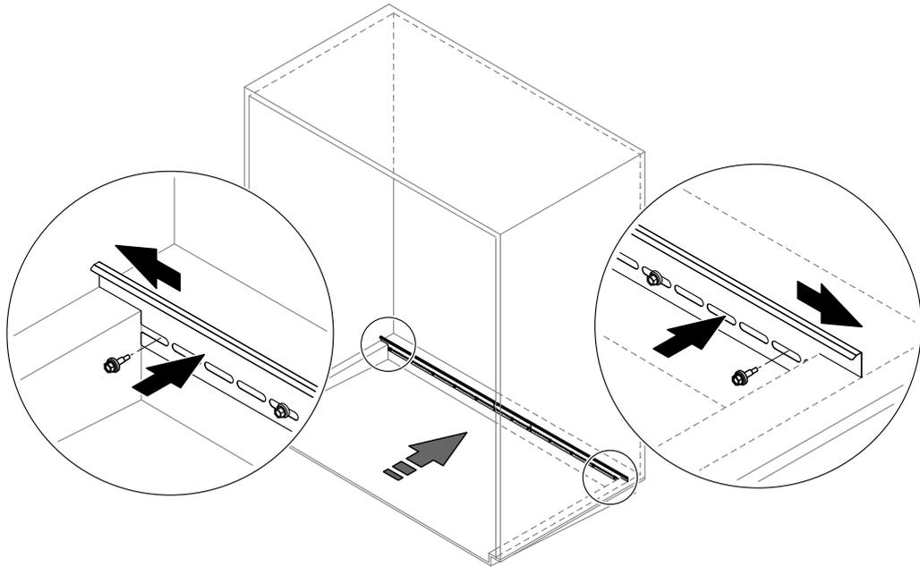
Abb. 6: Bodenblech montieren
