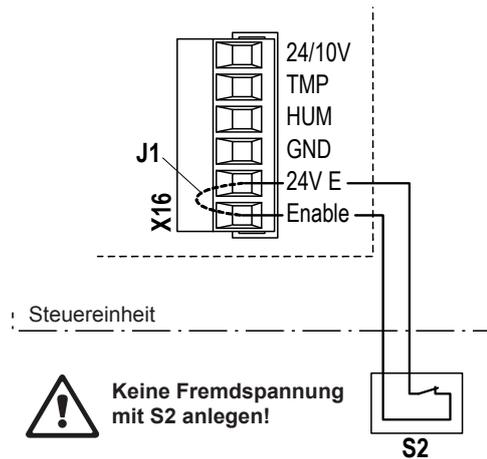
Der potentialfreie Kontakt eines externen Freigabekontakts wird gemäss dem Schema an die Klemmen "24V" und "Enable" der Klemmenleiste "X16" angeschlossen. Das Anschlusskabel ist entweder über die rechteckige Kabeleinführungsleiste oder eine freie Kabelverschraubung in die Steuereinheit zu führen.
