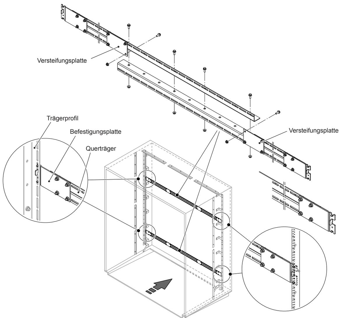
Abb. 10: Querträger montieren
