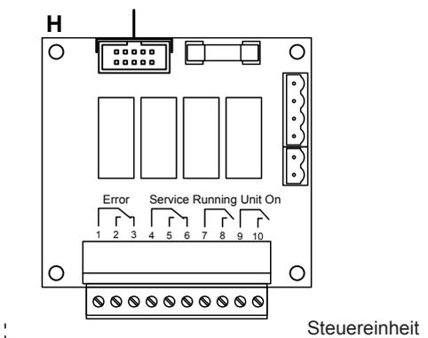
Die Betriebs- und Störungsferrmeldeplatine besitzt vier potentialfreie Relaiskontakte für den Anschluss folgender Betriebs- und Störungsmeldungen:
