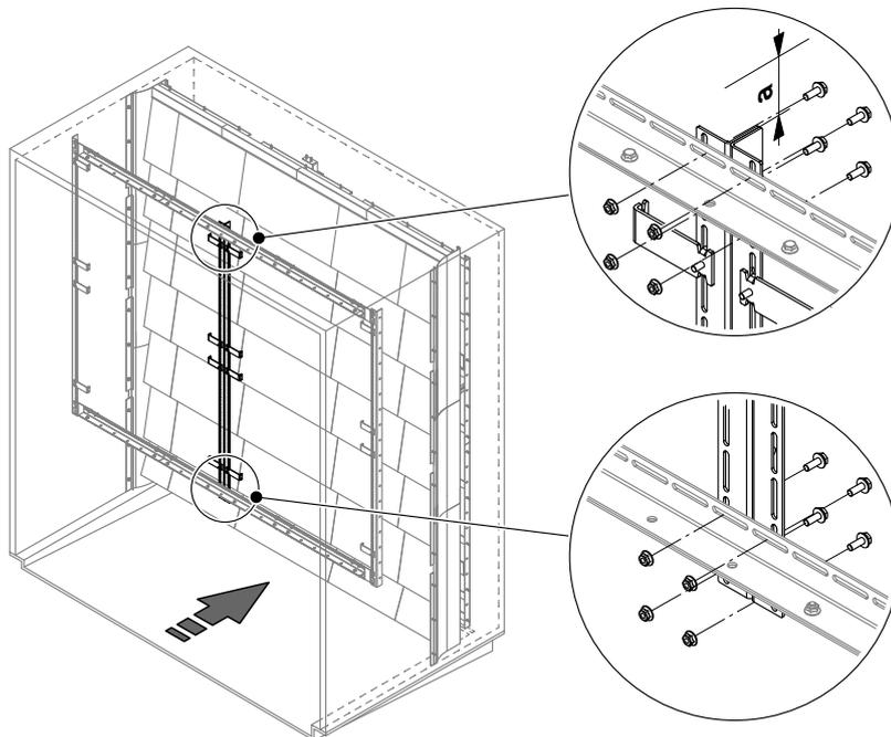
Abb. 28: Vertikalstütze(n) montieren
