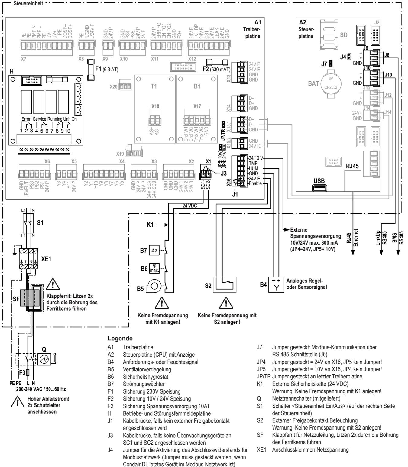
Abb. 39: Anschlussschema externe Anschlüsse
