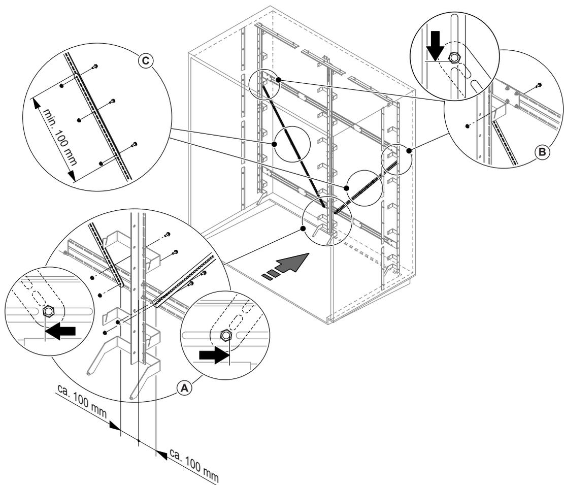
Abb. 14: Diagonalverstreben montieren
