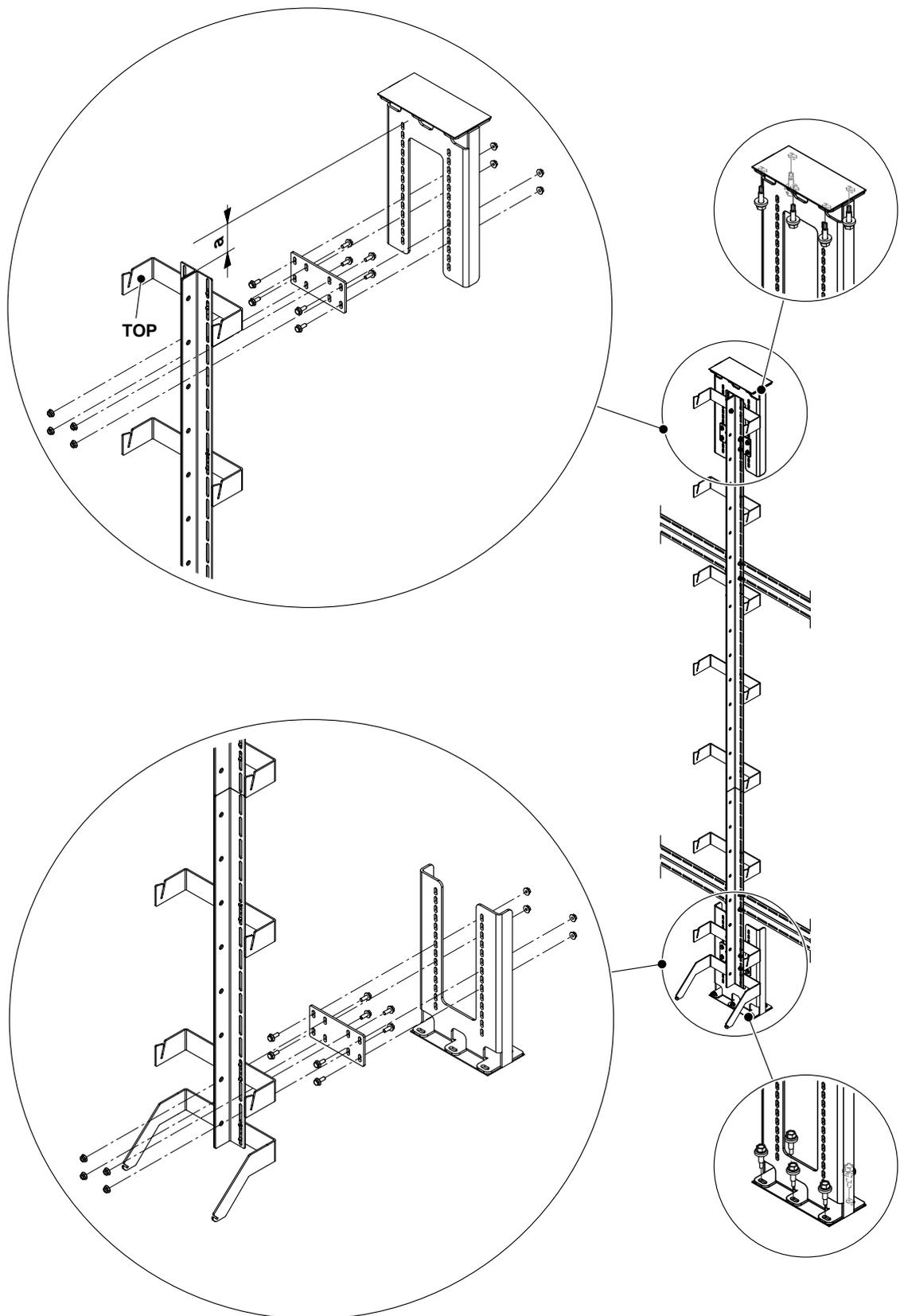
Abb. 13: Vertikalstütze(n) mit oberen und unteren Stützfuss montieren
