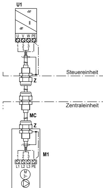
Das Motorkabel ist ab Werk am Frequenzumrichter (U1) in der Steuereinheit angeschlossen. Vor Ort muss das Motorkabel durch die Kabelverschraubung (oben links) in die Zentraleinheit geführt und gemäss dem Schema an den Motor der Druckerhöhungspumpe angeschlossen werden. Beim Durchtritt durch die metallene EMV-Kabelverschraubung (Z) an der Anschlussbox des Motors muss die Abschirmung des Motorkabels freigelegt werden, damit diese mit der Kabelverschraubung elektrische Verbindung hat.
