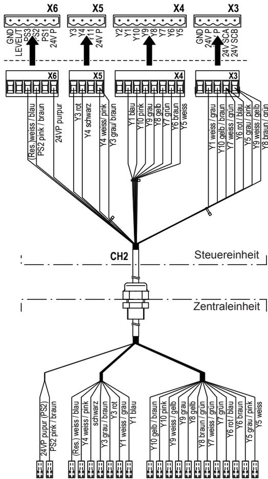
Der Kabelbaum "CH2" (Ventile) ist ab Werk an den entsprechenden Ventilen in der Zentraleinheit angeschlossen. Vor Ort müssen die Stecker des Kabelbaums gemäss dem Schema auf die entsprechenden Anschlussbuchsen (X3-X6) auf der Treiberplatte in der Steuereinheit aufgesteckt werden. Der Kabelbaum ist über die rechteckige Kabeleinführungsleiste in die Steuereinheit zu führen.
