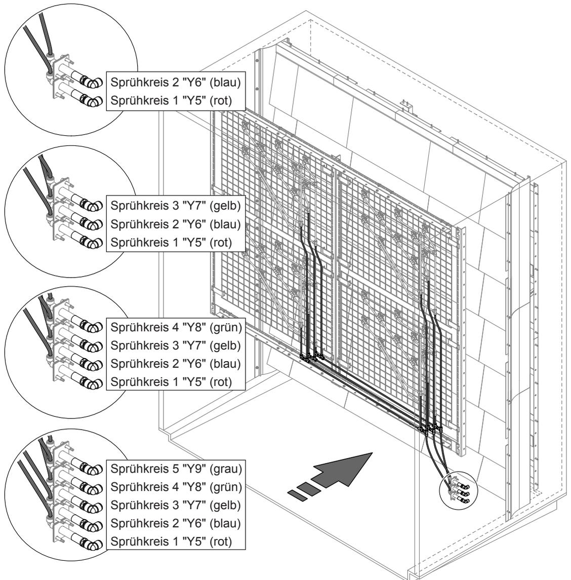
Abb. 33: Sprühkreise verbinden und an die Wanddurchführungen anschliessen
