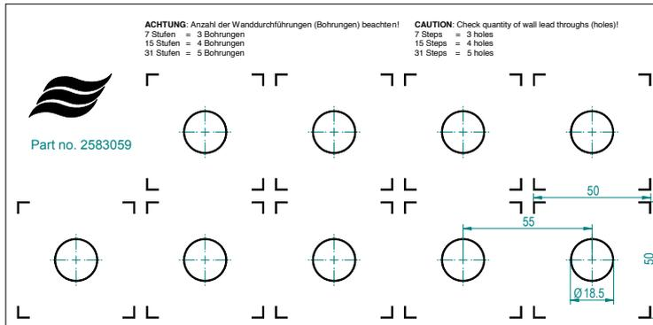
Abb. 31: Bohrschablone Durchführungslöcher
