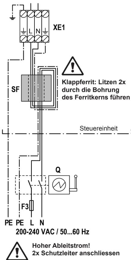
Anschluss der **Spannungsversorgung** (L1, N und 2xPE) erfolgt gemäss dem Elektroschema an die Klemmen "XE1". Die Litzen der Phase "L1", des Nullleiters "N" und eines der Erdleiter "PE" sind zweimal durch die Bohrung des beigelegten Klappferrits "SF" zu führen.
