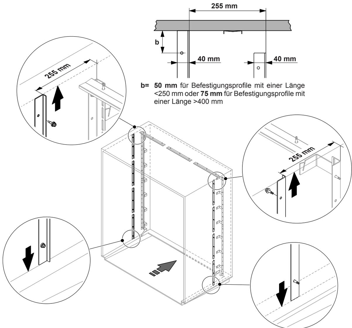
Abb. 9: Befestigungsprofile für die seitlichen Abdichtbleche montieren
