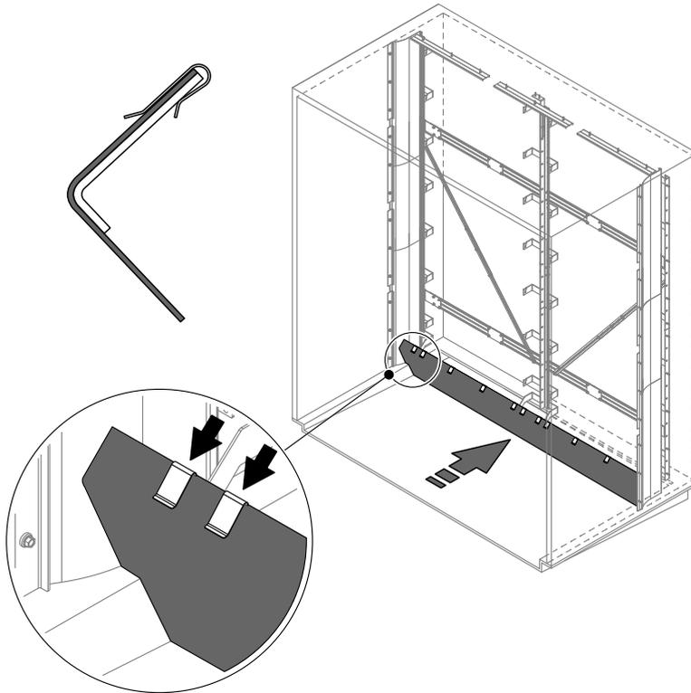
Abb. 20: Wannenabdichtgummi montieren
