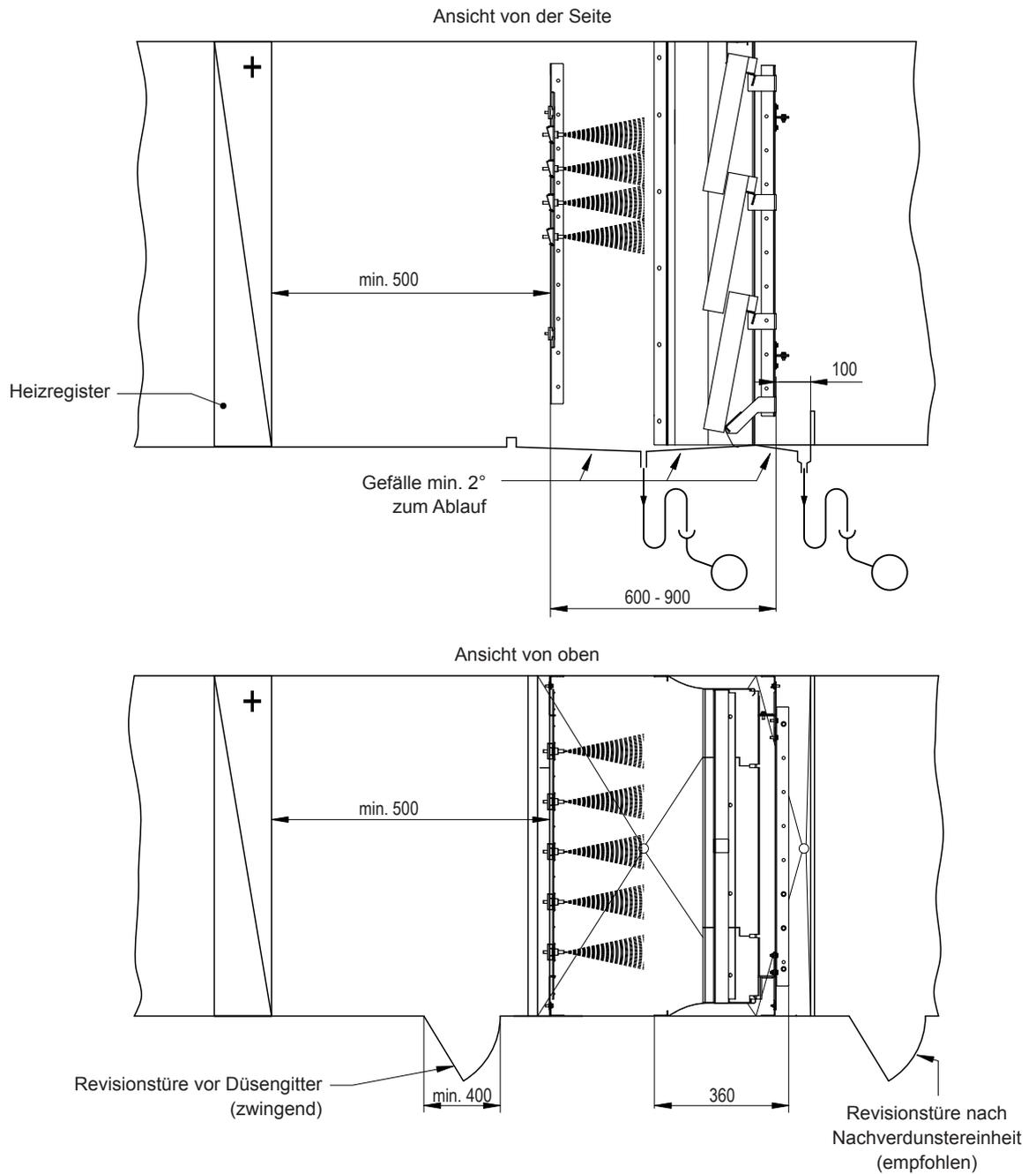
Abb. 3: Platzierung der Befeuchtereinheit mit Revisionstüre vor und nach der Düsen- und der Nachverdunstereinheit (Masse in mm)
