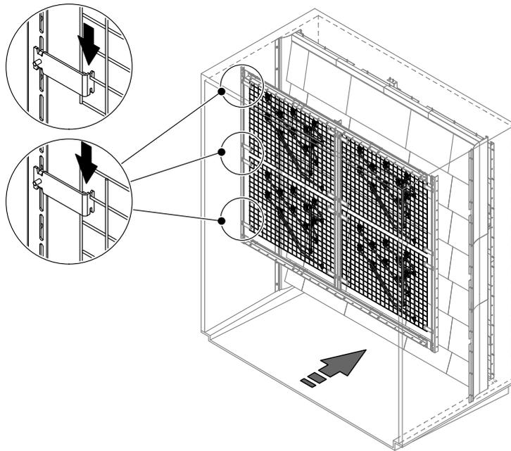
Abb. 30: Düsengitter einhängen
