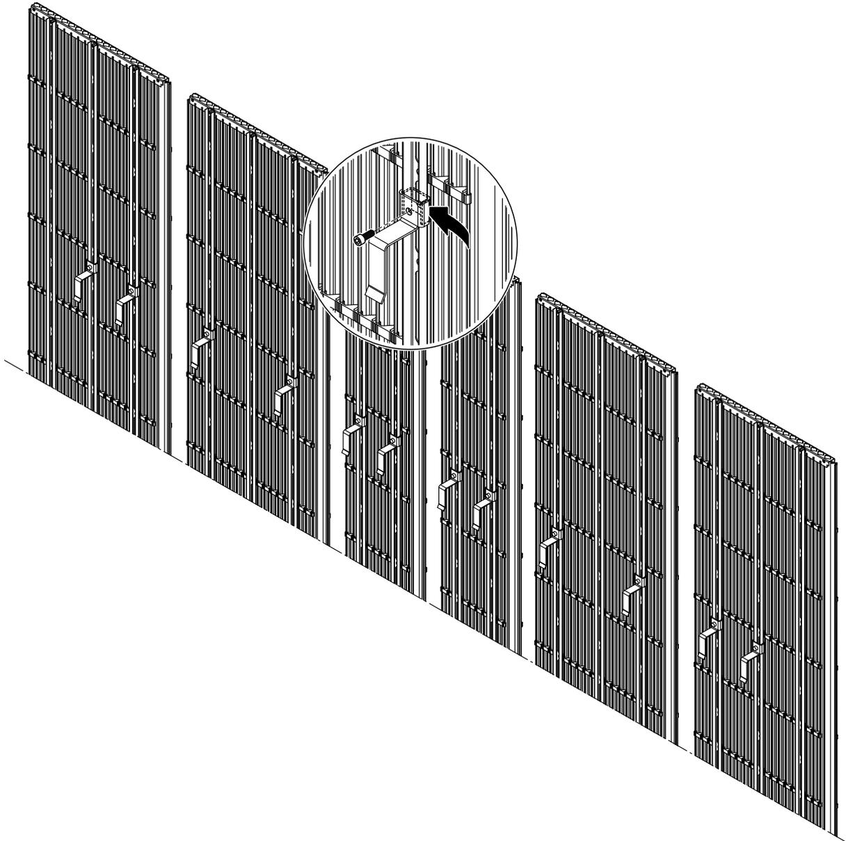
*Abb. 16: Obere Haltebügel an die Boosterelemente montieren*
