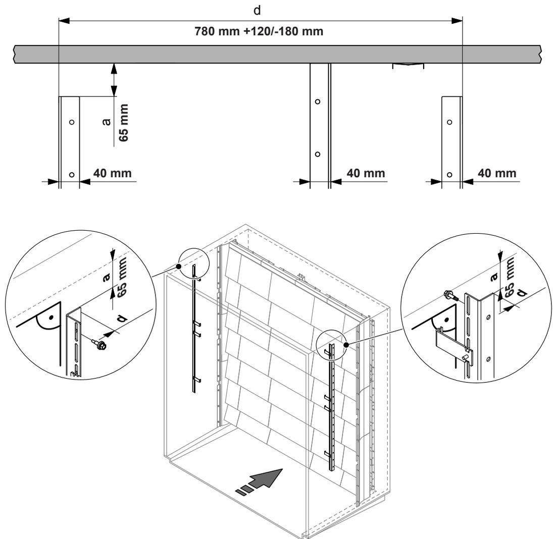
Abb. 25: Seitliche Trägerprofile montieren
