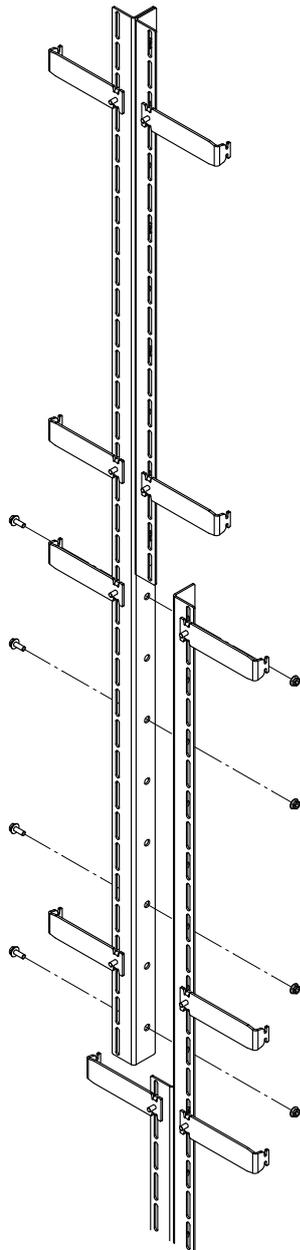
Abb. 27: Vertikalstütze(n) zusammenbauen
