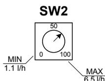
Le réglage de la limitation de débit s'effectue avec le commutateur rotatif SW2 de la platine de commande.
