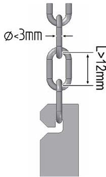
La pose des trois chaînes pour la suspension de l'appareil doit être effectuée par le client. Ces chaînes doivent se trouver verticalement (fixées au plafond) au-dessus des trois supports-cornières (fixés à l'appareil). Les points de fixation et les chaînes doivent présenter une portance suffisante pour le poids de l'appareil (consulter le chapitre 9.1 "Caractéristiques techniques").
