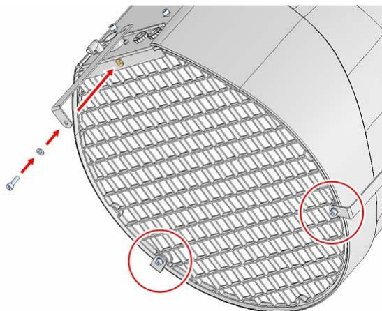
2. Fixer les trois cornières de fixation (livrées, pour le montage suspendu) à l'appareil au moyen d'une vis et d'une rondelle de chaque, comme indiqué sur l'illustration.
