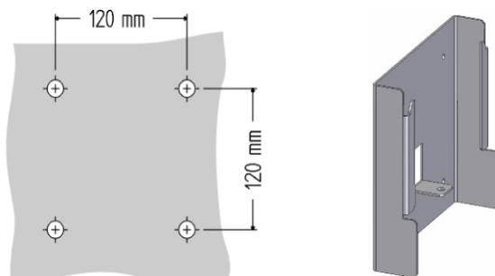
1. Marquer les trous de fixation à l'aide du support mural, à l'emplacement prévu. Avant d'effectuer le marquage, aligner le support horizontalement.
