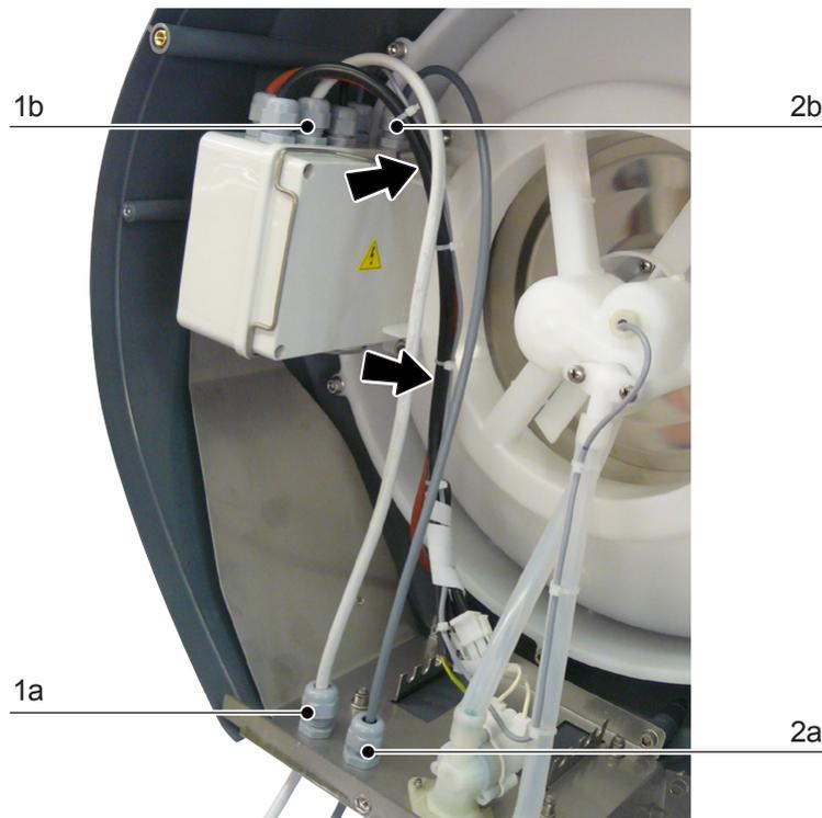
Faire passer le câble d'alimentation électrique dans l'appareil à travers l'étope "1a" et dans la boîte de commande à travers l'étope "1b" et effectuer les connexions à la platine de commande de la boîte de raccordement, selon le schéma.
