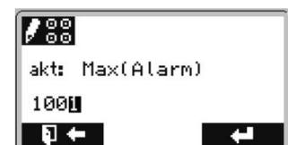
Wählen Sie **minimale Grenzwerte** für eine Warnung **Min(Warn)** bzw. für einen Alarm **Min(Alarm)** sowie **maximale Grenzwerte** für eine Warnung **Max(Warn)** bzw. für einen Alarm **Max(Alarm)** für den Fall, dass diese Leitfähigkeits-Werte über- bzw. unterschritten werden.
