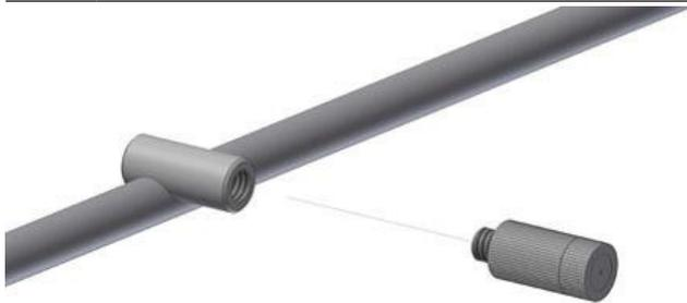
Abb. 20: Einsetzen der Düsen
