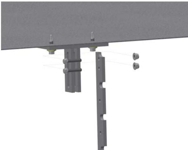
Abb. 17: Befestigung der Rohrhalterung
