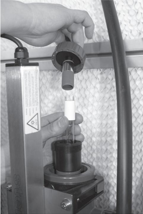
1. Desserrer l'écrou-raccord et retirer précautionneusement la fiche de raccordement vers le haut.
