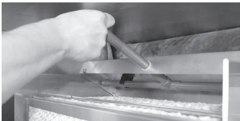
1. Desserrer les colliers de tuyaux et retirer les tuyaux des raccords du capot de ruissellement.
