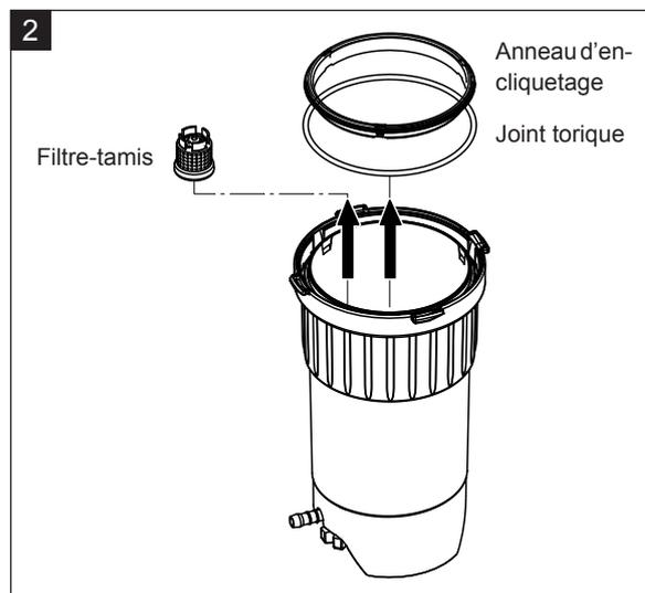
1. Pousser vers le haut la languette de la fermeture par encliquetage du réceptacle de récupération du calcaire et tourner le joint de fermeture à fond dans le sens des aiguilles d'une montre (1.). Tirer ensuite le joint de fermeture vers le bas jusqu'à la butée (2.), puis tourner à fond dans le sens inverse des aiguilles d'une montre (3.). Démontez le réceptacle de récupération du calcaire vers le bas (4.).
