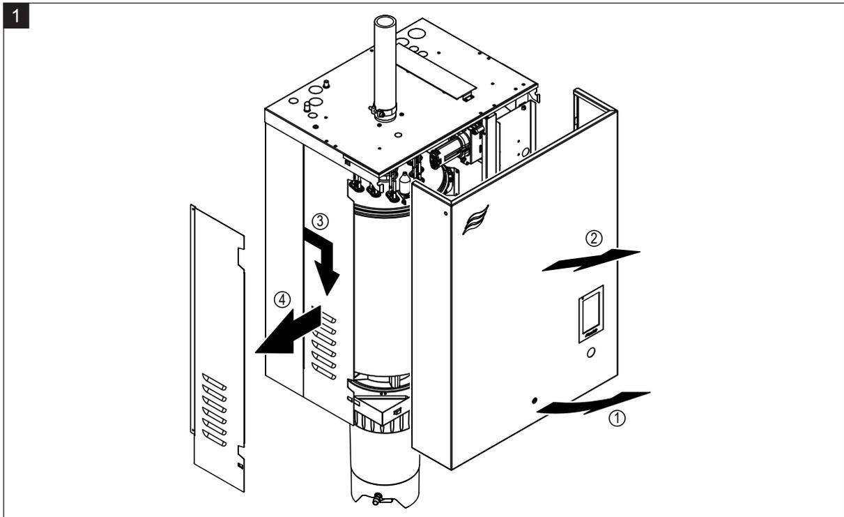
1. À l'aide d'un tournevis, desserrez la vis de fixation sur le cache avant ou sur le cache avant gauche (pour les gros appareils), puis retirez le cache avant. Tirer le panneau latéral gauche vers l'avant puis vers le bas et retirer le panneau latéral.
