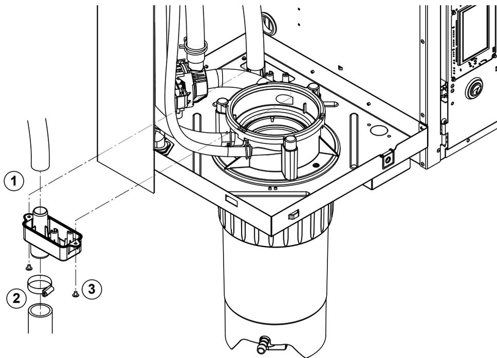
1. Séparer le tuyau d'évacuation du raccordement du godet.
