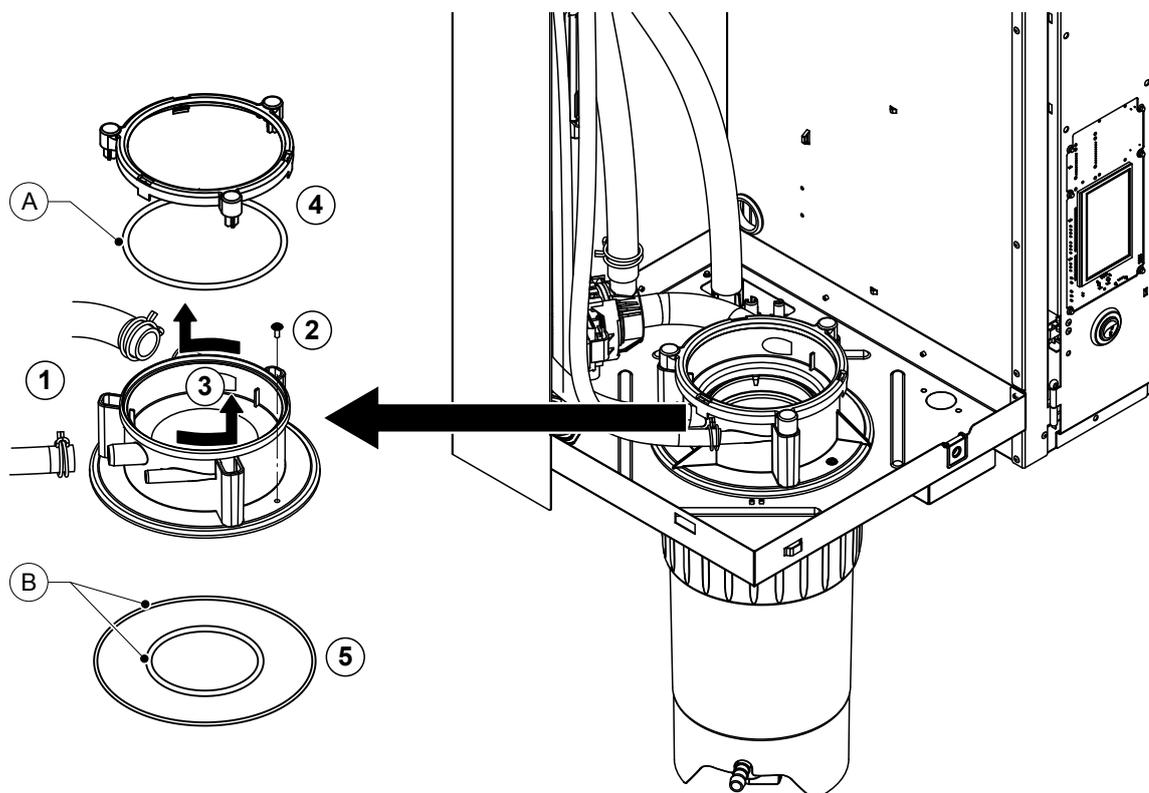
1. Desserrer les colliers de serrage et séparer les tuyaux des raccordements.
