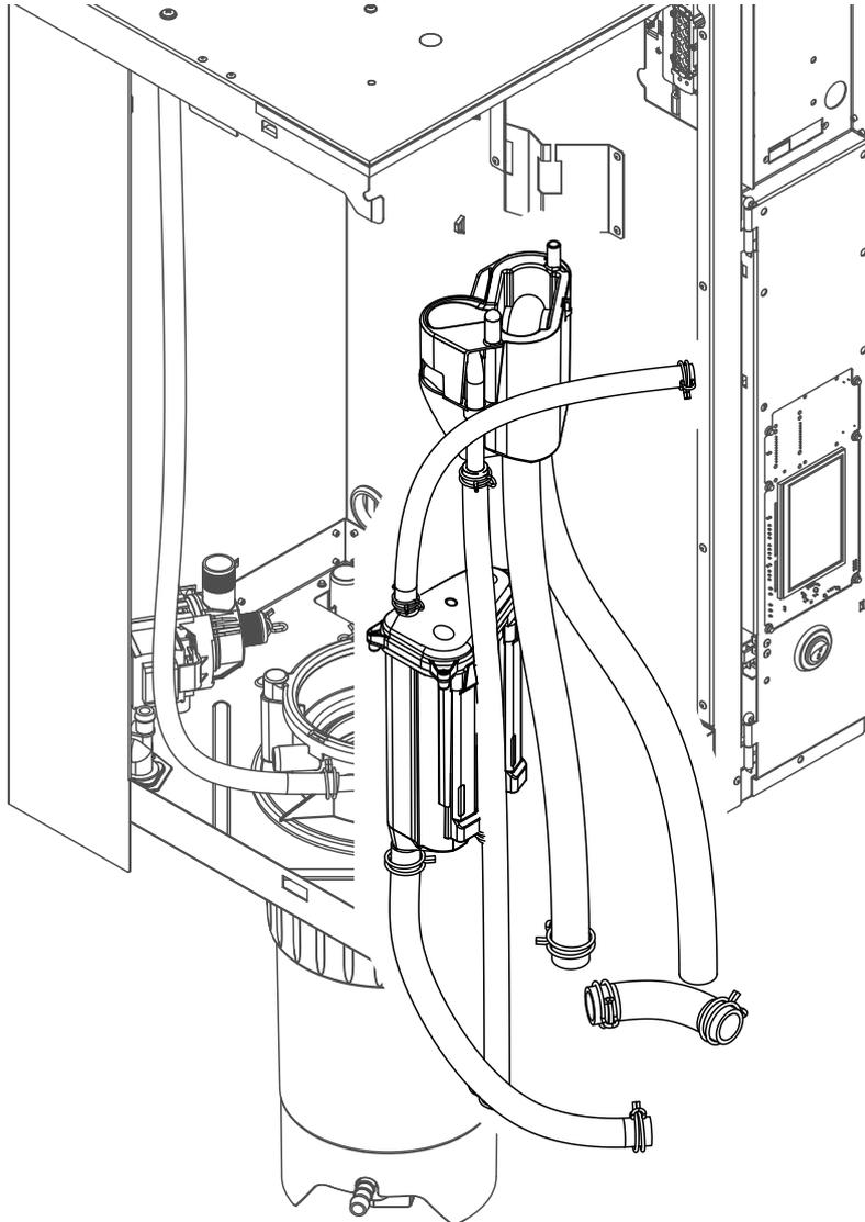
1. Desserrer le collier de serrage, séparer tous les tuyaux de l'appareil des raccords et retirer ces tuyaux.
