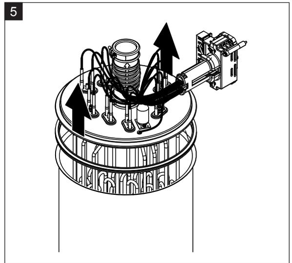
4. Desserrer l'anneau d'encliquetage du couvercle du cylindre à vapeur.
