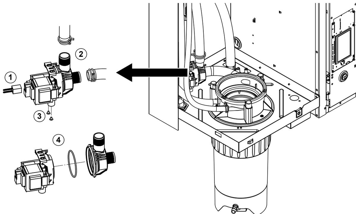
1. Débrancher les câbles électriques (inutile de respecter la polarité des câbles).
