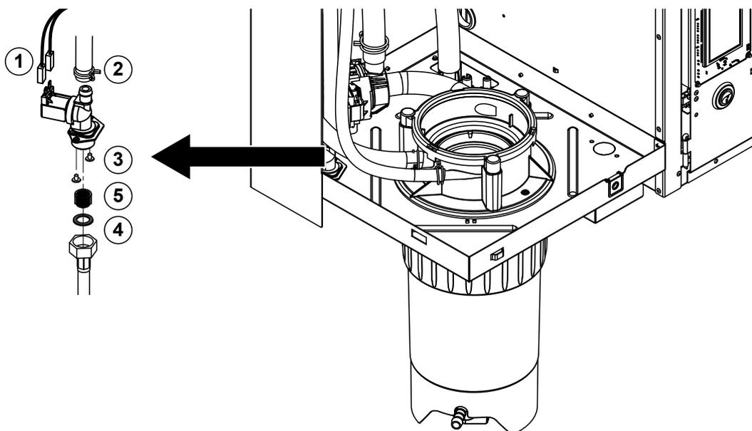
1. Débrancher les câbles électriques (inutile de respecter la polarité des câbles).
