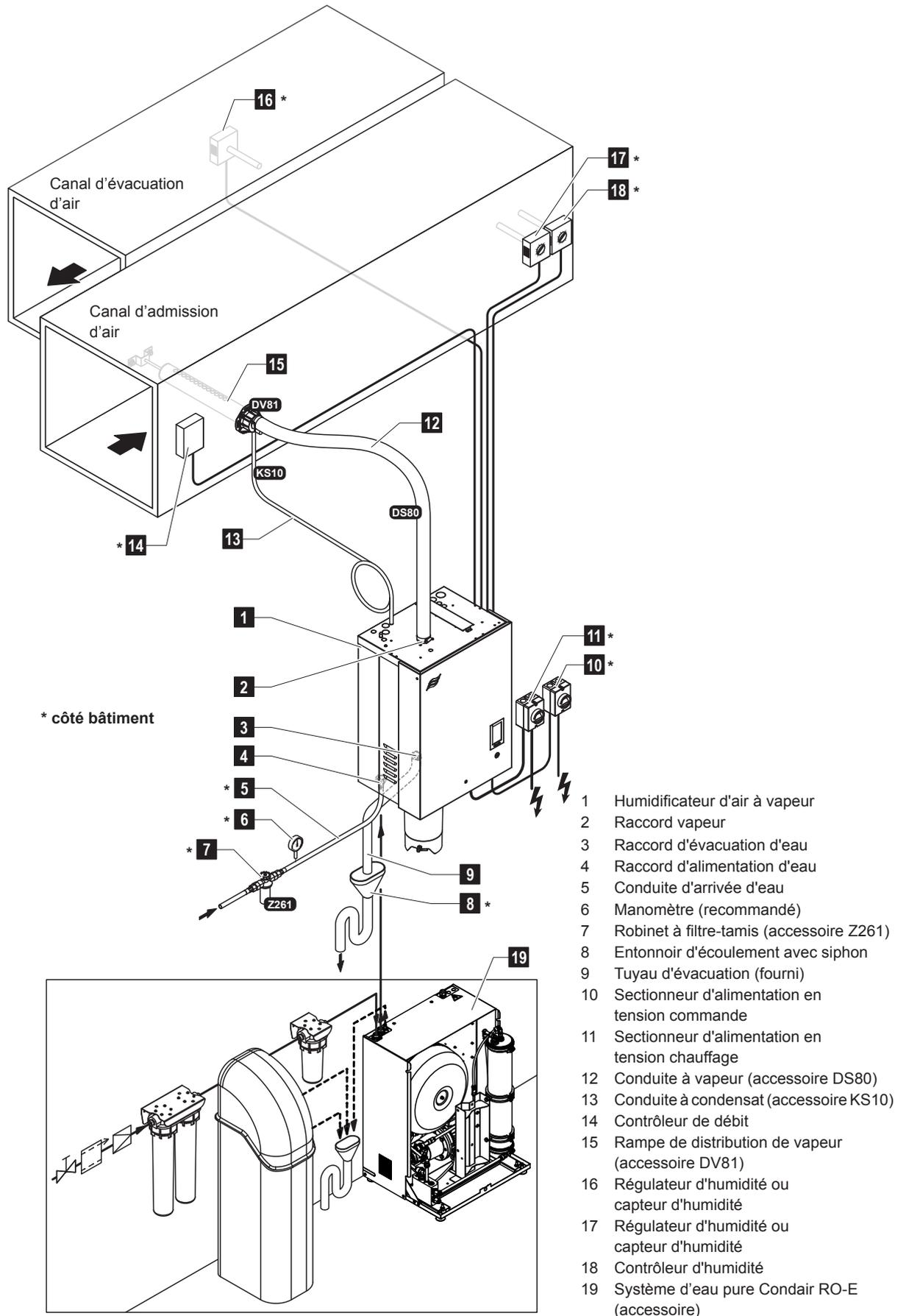
Fig. 2: Aperçu du système Condaïr RS d'humidification de gaine
