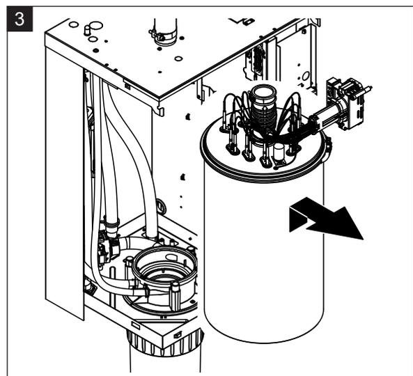
2. Dévisser le collier de serrage supérieur du connecteur vapeur avec un tournevis et séparer le connecteur vapeur du raccord vapeur en le tirant vers le bas. Desserrer ensuite les deux vis de la fiche du câble chauffant et la débrancher du bloc multiprise.
