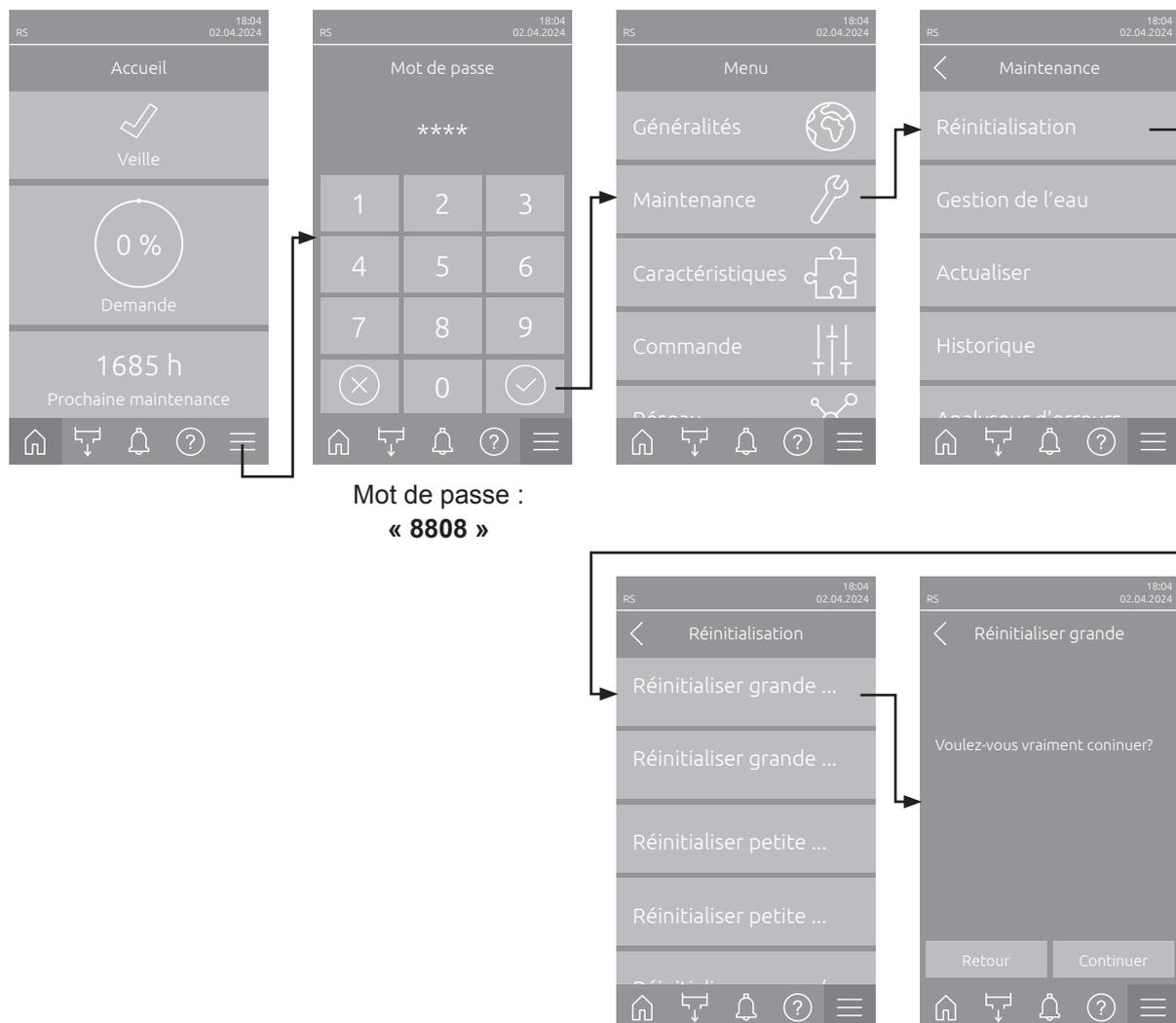
1. Sélectionnez le sous-menu « Réinitialisation » (chemin d'accès : « Menu > Mot de passe: 8808 > Maintenance > Réinitialisation ») et ensuite la fonction de réinitialisation correspondante (« Réinitialisation grande maintenance Cyl. A », « Réinitialisation grande maintenance Cyl. B », « Réinitialisation petite maintenance Cyl. A » ou « Réinitialisation petite maintenance Cyl. B »).
